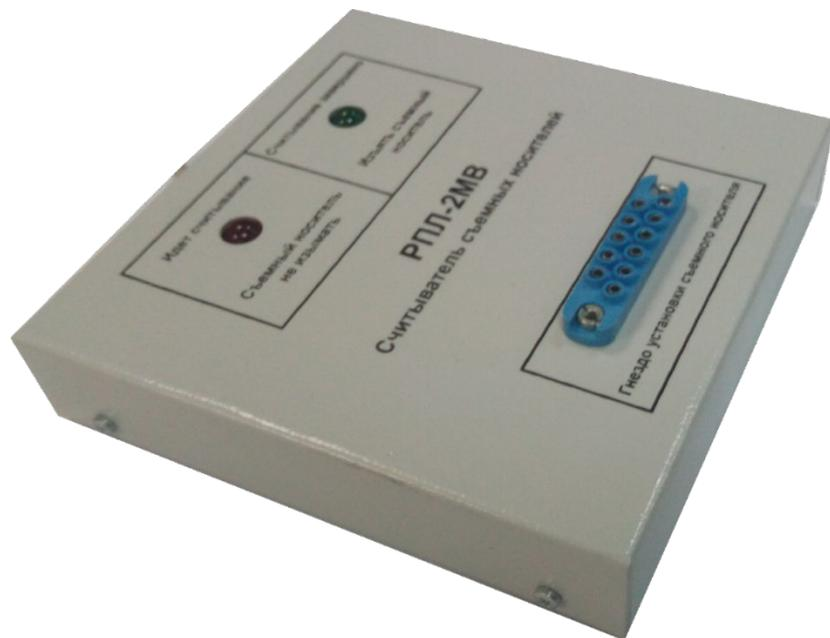
Рис. 2. Считыватель съемных носителей РПЛ-2МВ
